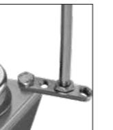
注意:对于直径超过 180 mm 的容器, 请将支杆结合延伸支杆使用(见“选配件”。
